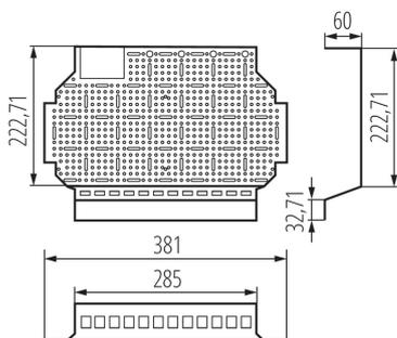
KDB-S/F Multimediakarten sind eine praktische Lösung, die elektrischen Schalttafeln in teletechnische (Multimedia-) Schalttafeln umzuwandeln. Die Medientafel wird einfach an der Stelle der DIN-Schiene montiert. Dabei werden lediglich die DIN-Schienen zerlegt und an ihrer Stelle die Multimedia-Karten eingesetzt. Das gilt für zweireihige KDB-Schaltanlagen für 12 und 18 Module (Unterputz/Aufputz-Montage).
